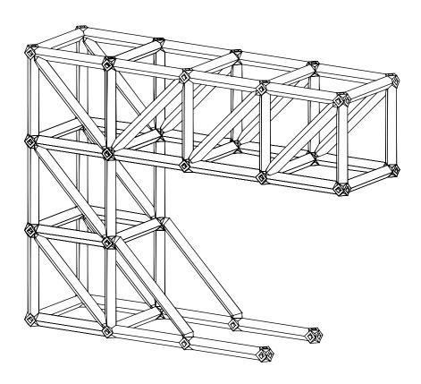
7. Wenn dreieckige Füllelemente in das innere Diagonalelement eingelegt werden, können gedeckte Flächen erstellet werden.
