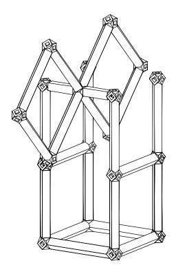
6. Für größere Stabilität bzw. Konstruktionssteifheit können Innen- oder Außendiagonalen in das Model eingesetzt werden.
