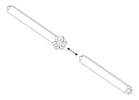
3. Der Dorn des Stabelements kann in den Zusammenbau-Kopf an fünf orthogonalen Seiten eingeschoben werden.
